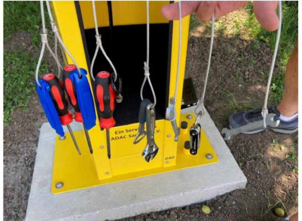
Werkzeuge der Radservicestation und Fußluftpumpe (Pedal seitlich)
